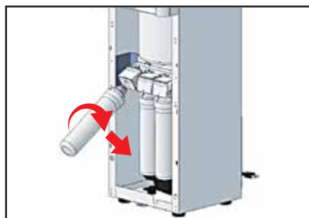
⑥ フラッシングが終わった新しいフィルターを右に回してから下げてください。
