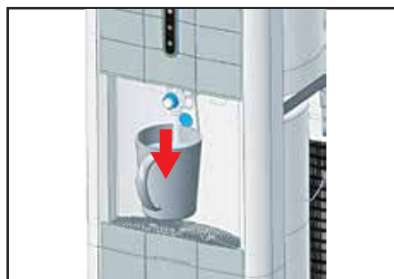
④ 冷水コックからタンク内部の水を排水します。
