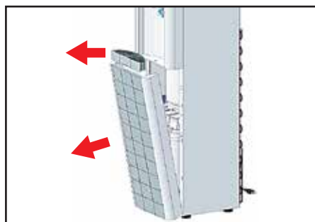
③ 受け皿を取り外した後、下部板カバーを取り外します。
